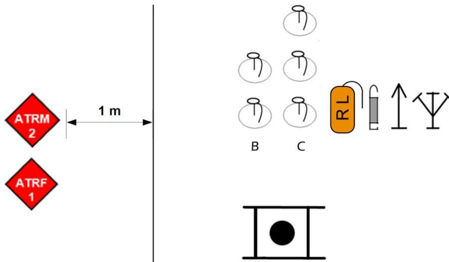
Die Bewerber rüsten sich mit den notwendigen Ausrüstungsgegenständen aus und bauen die Zubringerleitung zwischen abgestellter TS und dem vom Hauptbewerter vorgegebenen Verteilerstandort auf. Beim Ankuppeln an die TS ist der Schlauch mit dem Fuß zu sichern. Ebenso sind die B-Schläuche gemeinsam zu kuppeln.
