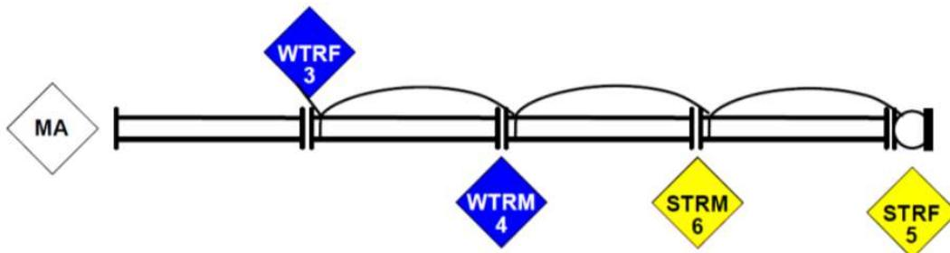
Sobald das letzte Kupplungspaar gebunden ist, gibt der MA das Kommando „Saugleitung zu Wasser“. Je nach Situation können auch weniger als 4 Saugschläuche verwendet werden. Die Anzahl der zu verwendenden Saugschläuche werden vom MA bestimmt. Federführend verantwortlich hierbei ist der STR.
