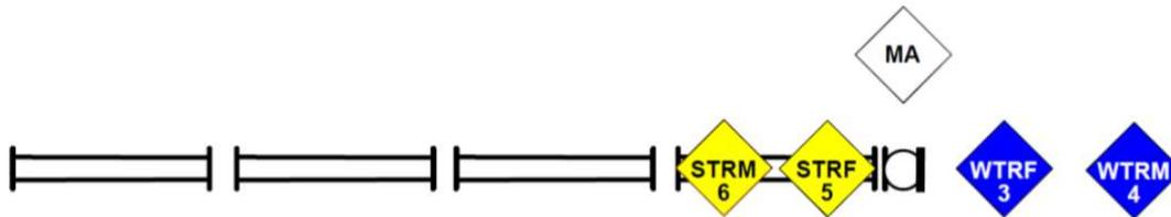
Der MA übergibt dem WTRF den Saugkorb zum Kuppeln. Der WTRM übernimmt vom MA die Leinen und legt diese griffbereit links und rechts des WTRF ab. Die zu kuppelnden Schläuche werden zwischen den Beinen waagrecht etwa in Kniehöhe angehoben, wobei die Truppführer kuppeln. Der MA übergibt die Kupplungsschlüssel griffbereit den Truppführern, welche mit diesen die Kupplungen festziehen. Händisch kuppeln und mit den Kupplungsschlüsseln nachkuppeln.
