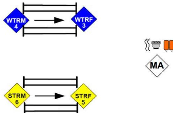
Der STR trägt die Saugschläuche zum ausgewählten Kupplungsbereich und legt zuerst den links getragenen Saugschlauch so ab, dass alle restlichen Saugschläuche noch bis zum MA Platz haben. Anschließend legt er den rechts getragenen Saugschlauch ab. Der WTR schließt mit dem links getragenen und dann mit dem rechts getragenen Saugschlauch an.
